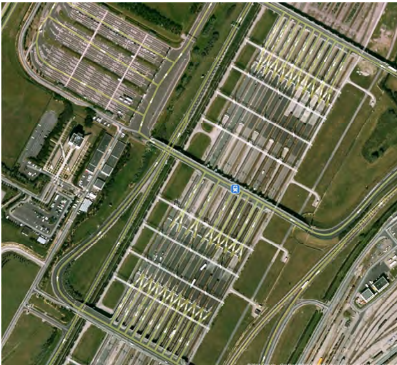
Abbildung 15: Warteraum (links oben) und Beladeplattformen durch zwei Zufahrtsrampen erschlossen und unten im Bild die Abfahrtsrampe für das Verlassen der Beladeplattformen ( http://maps.google.ch/maps , 08.09.2011)
