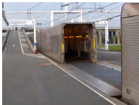
Abbildung 4: Terminal für den Eurotunnel mit einem Auffahrwagen für seitliches Auffahren
