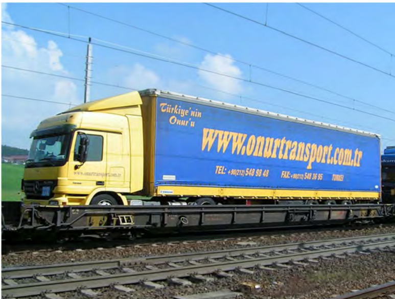
Abbildung 5: Niederflurwagen Saadkms 690 beladen mit LW
