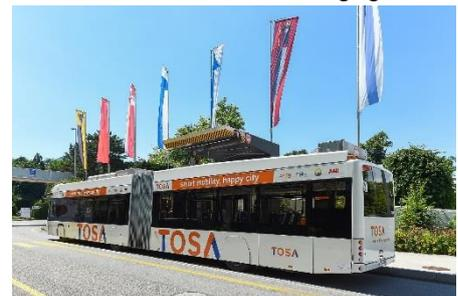
Die Batterien des TOSA-Busses werden über sogenannte «Flash»-Ladestationen in rund 20 Sekunden an den Bushaltestellen auf der Strecke teilaufgeladen, sowie an den Endhaltestellen während der Wartezeit von 4 bis 5 Minuten vollständig geladen.
